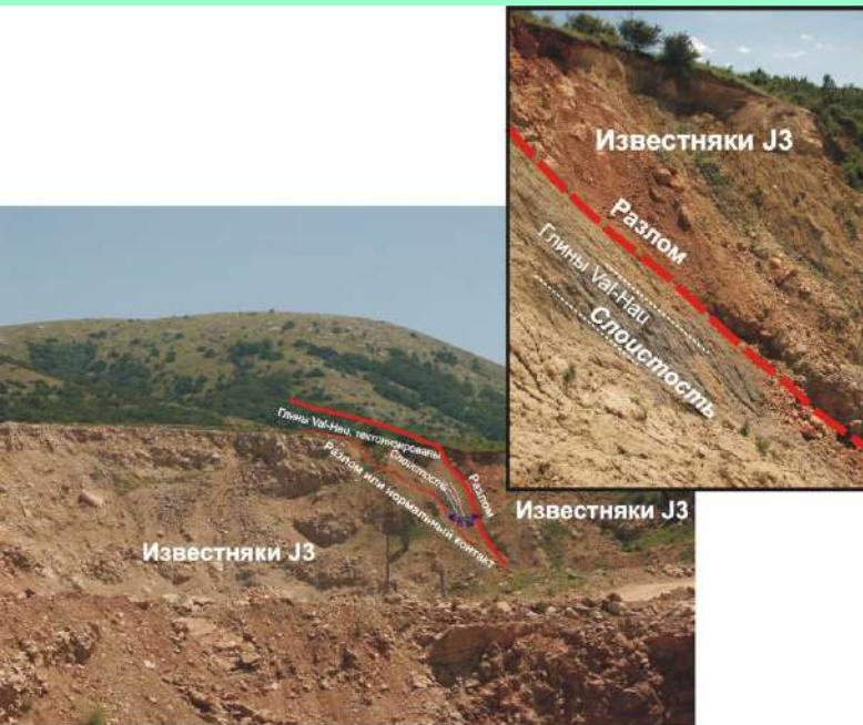
Рис. 28. Схема строения предполагаемого тектонического клина нижнемеловых отложений в известняках верхней юры в Мраморном карьере. Справа - фото контакта детальнее
